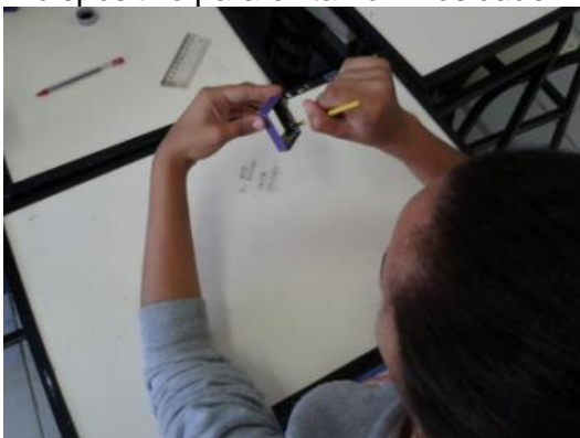
(Fig.20) Pintado o interior da caixa do dispositivo para evitar luminosidade
