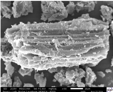
Figura 4 – Micrografias de biocarvão de lodo de esgoto + bagaço de cana-de-açúcar em microscopia eletrônica de varredura com diferentes aumentos: 700 (a), 600 (b), 200 (c), 180 (d), 370 (e) e 1200 (f) vezes
