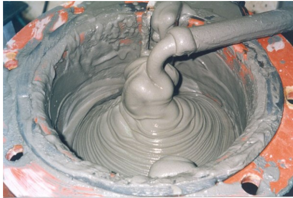
Figura 2.7 – Exemplo de Rejeito Espessado de Ultraelevada Densidade (Pasta)
