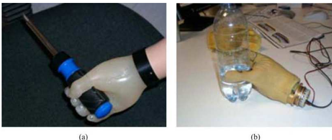
FIGURA 14 - (a) Protótipo de Silicone. (b) Protótipo de Poliuretano
