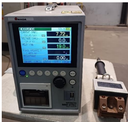
Figura 20 – Equipamento de monitoramento da marca Miyachi, modelo MM 370.
