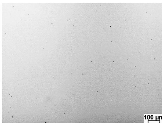
Figura 50 – Aspecto típico das inclusões observadas na amostra do aço CP1000EG. Amostra como polida.
