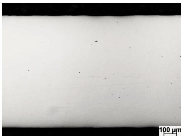
Figura 31 – Aspecto típico das inclusões observadas na amostra do aço DP1000EG. Amostra como polida.
