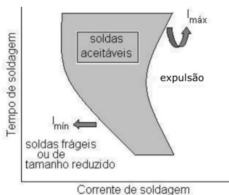
Figura 6 – Gráfico corrente x tempo de soldagem (representação esquemática de um campo de soldabilidade – soldas aceitáveis) (11) .
