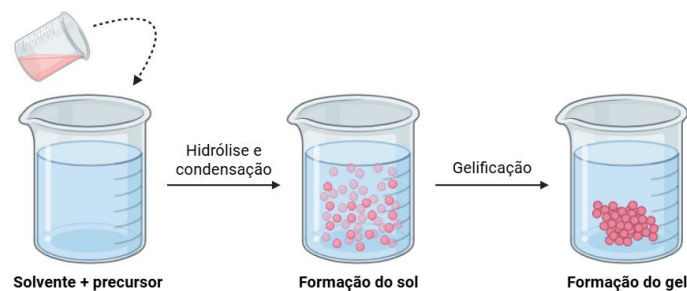
Figura 8. Esquema simplificado das etapas de obtenção de um sistema sol-gel (Fonte: autoria própria).
