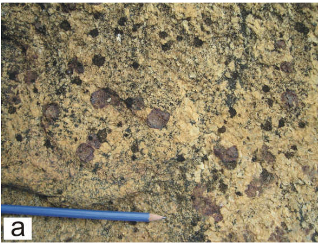
Fig. 25 – Leucogranito da supersuíte G3 com (a) fenocristais de granada e (b) agregados de granada e cordierita. Afloramento próximo à cidade de Rio do Prado (UTM 0336207/ 8160751).
