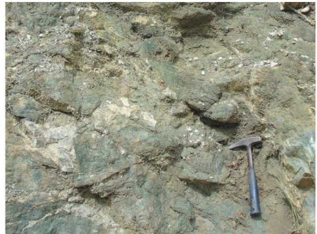
Fig. 14 – Rocha metaultramáfica em afloramento em corte de estrada, entre Joáima e Felizburgo (UTM 0298840/ 8151846).
