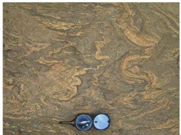
Fig. 8 - Gnaiss kinzigítico migmatítico com dobras ptygmáticas. Afloramento na margem norte do Rio Jequitinhonha, próximo à cidade de Almenara (UTM 0313438/ 8208278)
