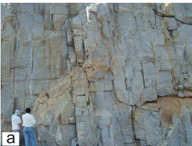
Fig. 19 - Granito Felizburgo (G1), (a) cortado por mobilizados pegmatóides quartzo-feldspáticos com biotita e (b) com bandamento gnáissico. Afloramento em corte de estrada, a leste de Felizburgo, entre essa cidade e Rio do Prado (UTM 0318014/ 8159138).
