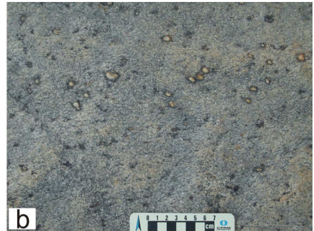
Fig. 22 - Granito Maranhão foliado (G2), (a) com restito de gnaiss kinzigítico e (b) resíduos de fusão representados por cristais centimétricos de sillimanita. Afloramento no leito do Rio Jequitinhonha, próximo ao centro urbano da cidade homônima (UTM 0286119/8182431)
