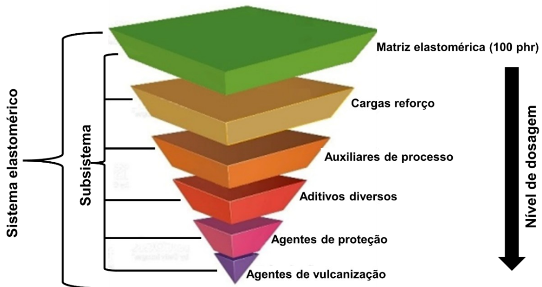
Figura 12 - Sistema hierárquico para a formulação de compostos de borracha. Fonte: (RODGERS; WADDELL, 2013)
