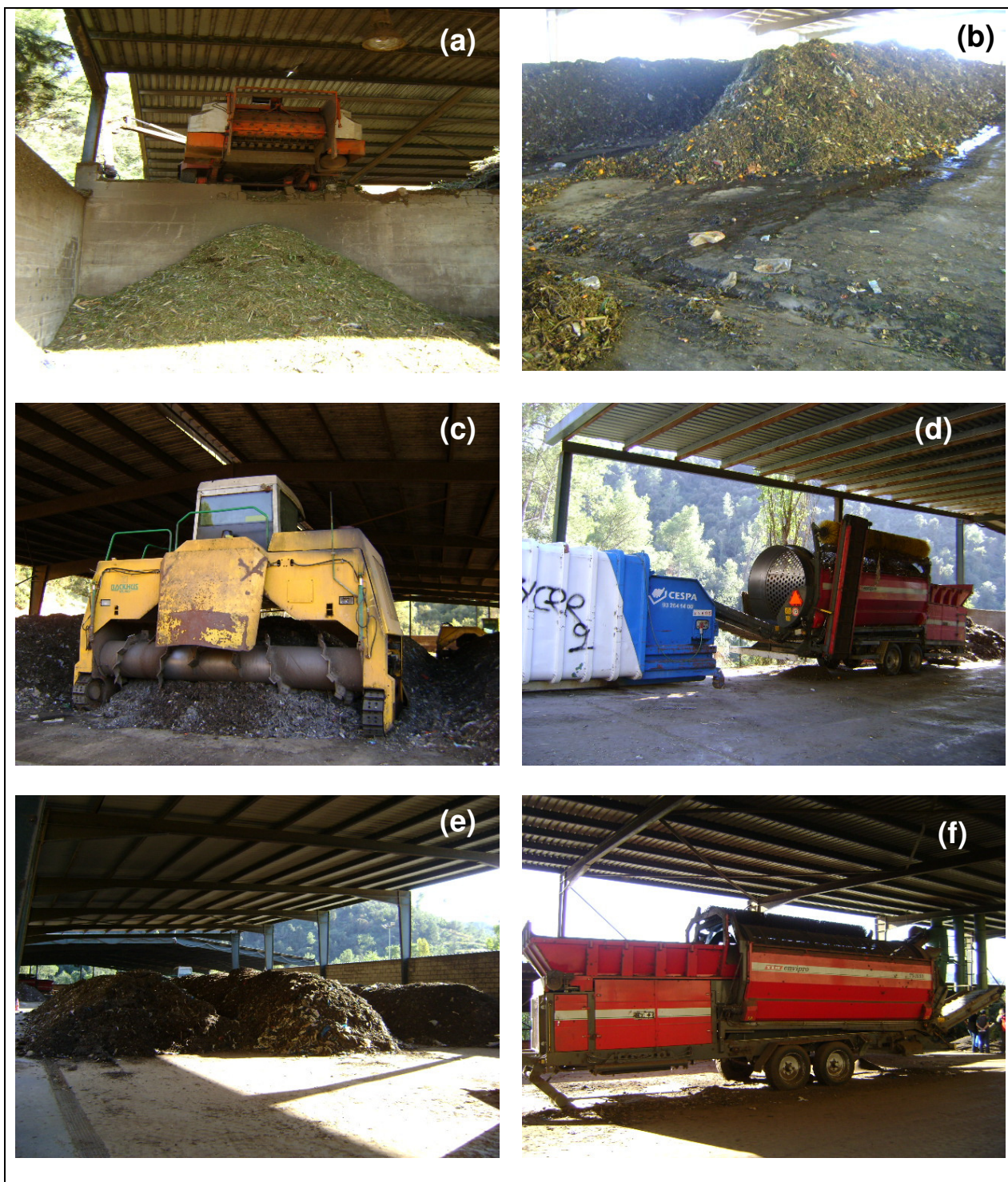
Figura 5.19 – Principais partes da Unidade de Triagem de Torrelles de Llobregat – Vista externa da unidade Triturador (a), Área de fermentação (b), Revolvedora (c), Peneira (d), Área de maturação (e) e Afinamento (f).
