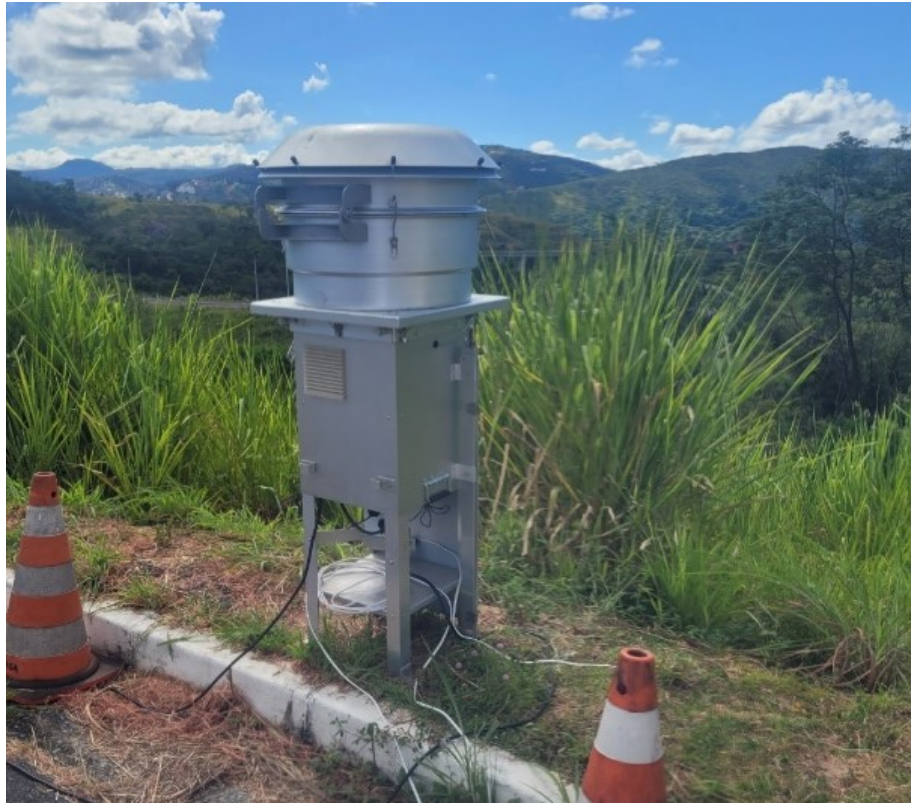
Figura 4.8 – Amostrador de grande volume a montante da ETE B
