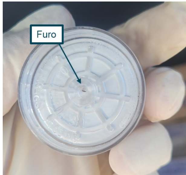
Figura 5.1 – Furo em membrana de gelatina no amostrador posicionado no canal de afluente dos decantadores na ETE B
