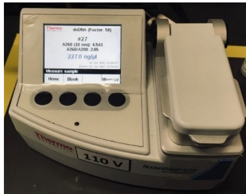
Figura 4.14 – NanoDrop™ utilizado para quantificar o material genético extraído
