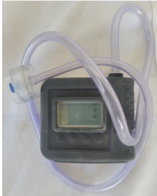
Figura 4.9 – Bomba de amostragem digital Accura-3 (CRIFFER®) conectada a cassete
