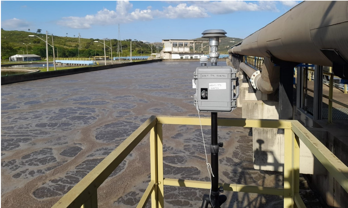
Figura 4.6 – Amostrador de médio volume no reator de lodos ativados
