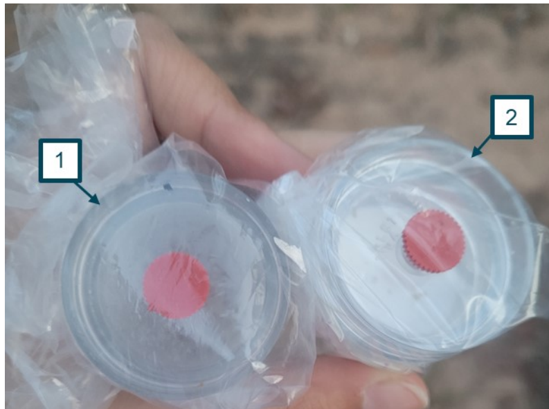
Figura 5.2 – Diferença de coloração das membranas de gelatina de amostradores posicionados no canal de afluente dos decantadores (1) e na entrada do lodo de retorno (2)
