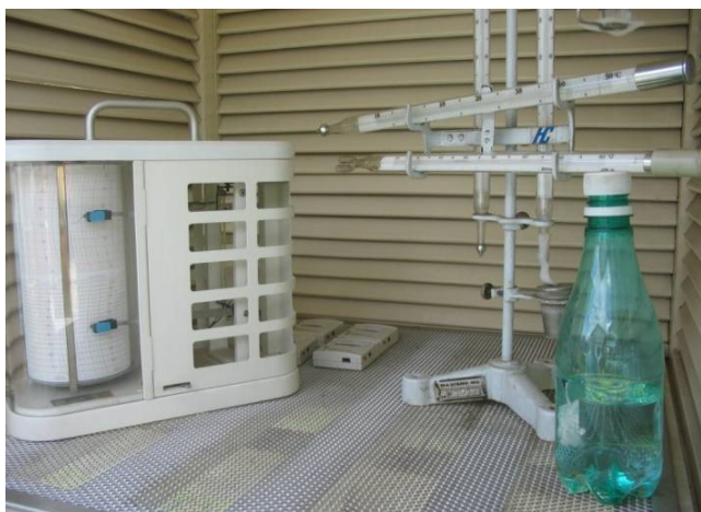
Figura 28 - Foto dos equipamentos tipo HOBO U12-012 dentro do abrigo da estação principal do INMET/5DISME em Belo Horizonte
