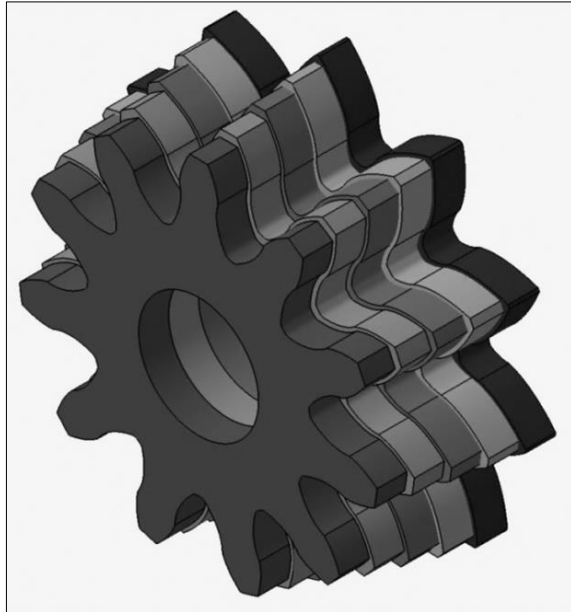
FIGURA 5.23 - Modelo 3D de engrenagens cilíndricas retas com 11 dentes, com ângulos de pressão de 25^\circ , sem fator de correção de perfil, fator de correção de perfil 0.5, 0.25, -0.25, -0.5.
