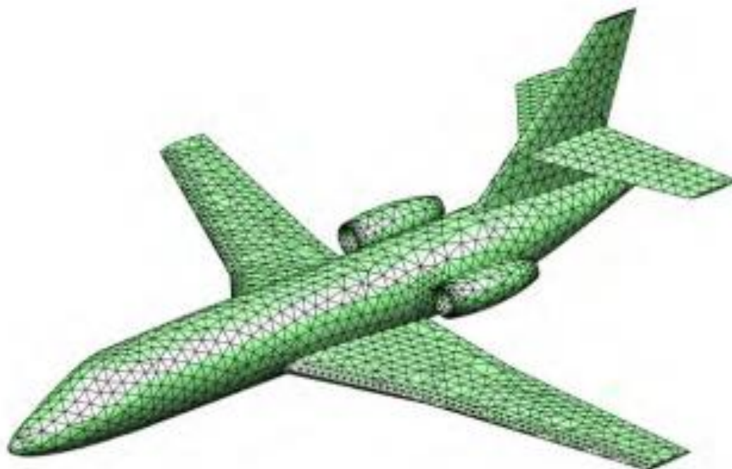
Figura 13 – Discretização de um domínio contínuo (XIE et al. , 2013).
