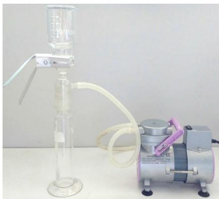
**Figura 12-** Sistema de filtração em escoamento frontal à membrana.
