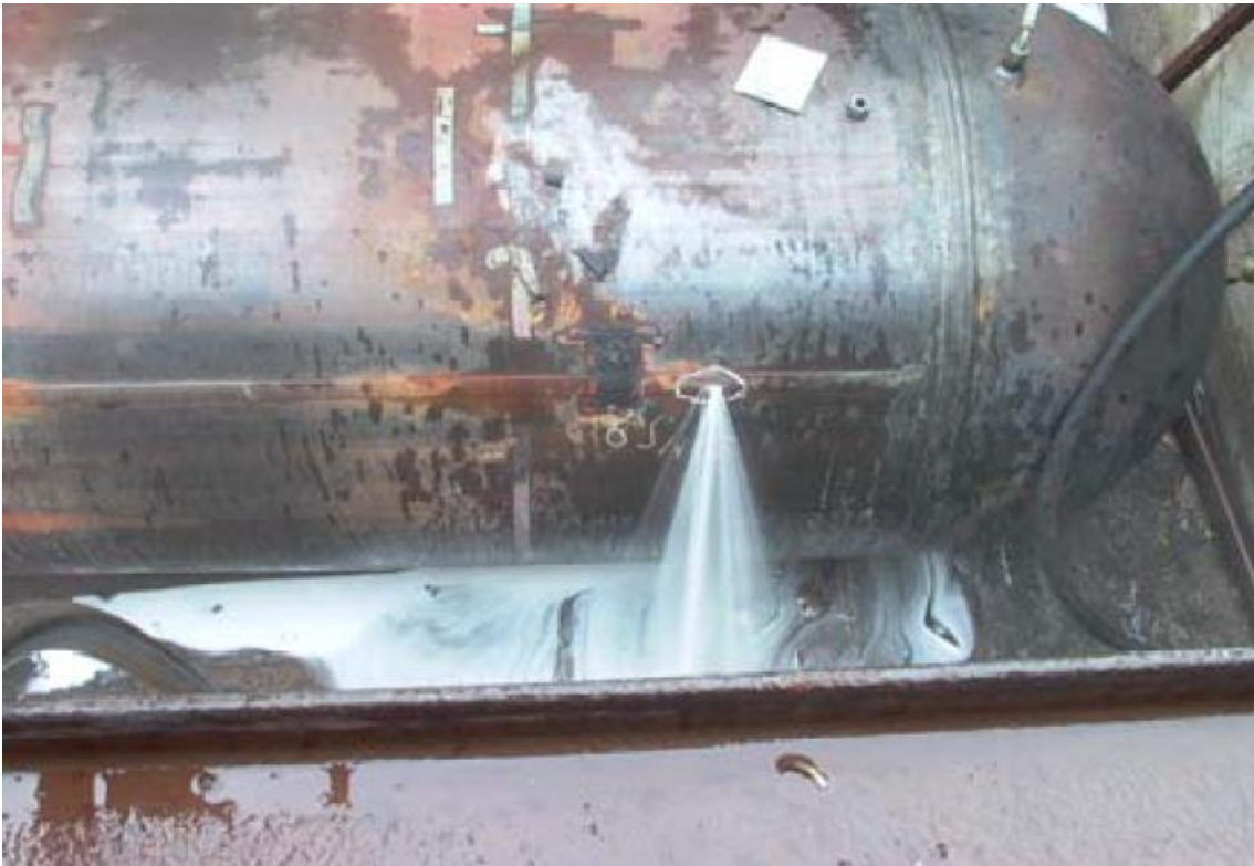
FIGURA 2. 16 – Falha em fadiga da solda longitudinal de um teste em escala real
