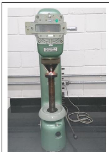
Figura 3.6: Durômetro Heckert modelo HPO 250.
