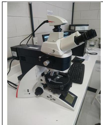
Figura 3.16: Microscópio óptico Olympus Leica DM 4500.
