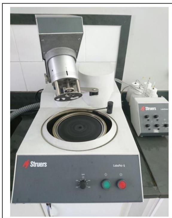
Figura 3.4: Politriz utilizada para lixamento e polimento das amostras metalográficas.
