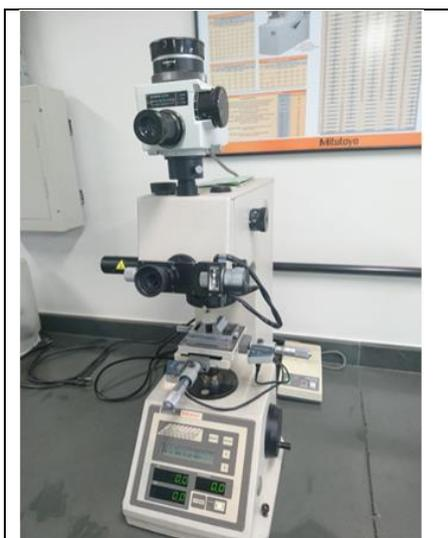
Figura 3.17: Microdurômetro Vickers MVK-H1.
