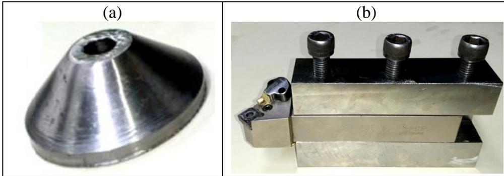
Figura 3.8: Equipamentos utilizados nos ensaios: (a) cone utilizado no cabeçote móvel e (b) suporte para o porta-ferramenta.
