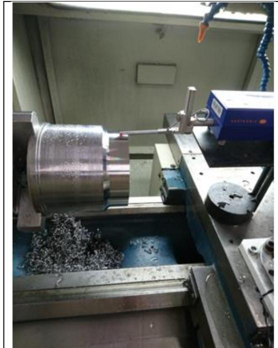
Figura 3.19: Medição da rugosidade dos corpos de prova.
