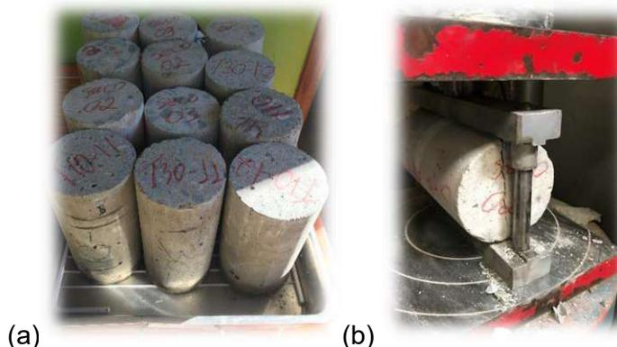
Vale abordar que após o rompimento, permite observar a distribuição de água no seu interior, conforme ilustra a Figura 4.24.
