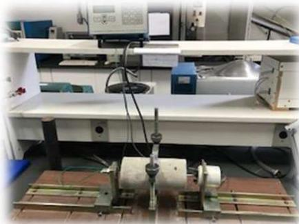
Baseado na norma NBR 6118 (ABNT, 2014), o módulo de elasticidade estático deve ser realizado segundo o método de ensaio estabelecido na NBR 8522 (ABNT, 2017), sendo considerado nesta norma o módulo de deformação tangencial inicial do concreto ( $E_{ci}$ ), obtido aos 28 dias de idade.
