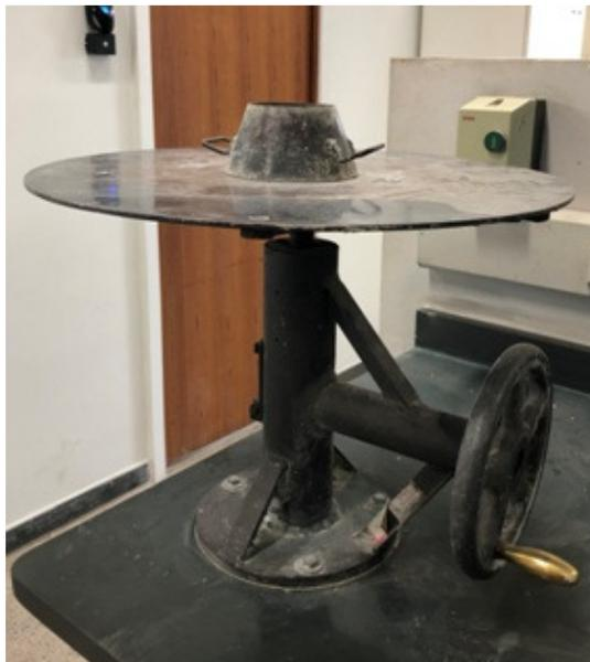
Figura 4.6 - Dispositivo utilizado na execução do teste *Flow Table*.
