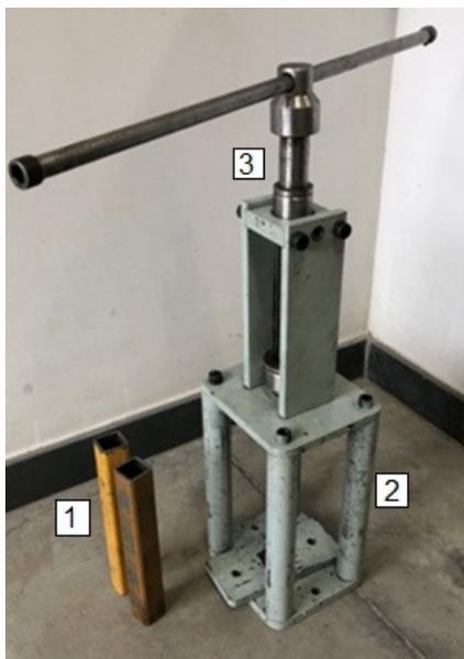
Figura 4.5 – Aparato utilizado para auxiliar na melhoria da densidade do concreto. (1) Moldes dos corpos de prova, (2) matriz e (3) punção.
