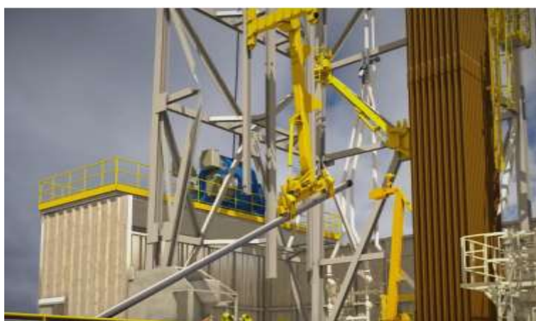
Figura 3.2– Tubo casing sendo içado pelo elevador em um navio.
