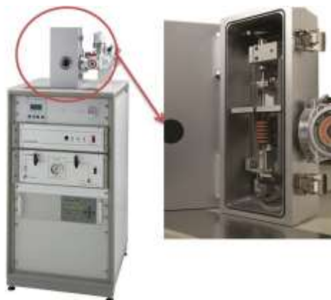
Figura 4.2 - Fotografias do Dilatômetro de Têmpera R.I.T.A. L78 do Laboratório de Tratamentos Térmicos e Microscopia Óptica da Universidade Federal de Ouro Preto (UFOP).
