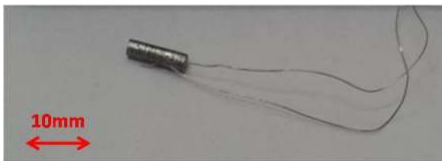
Figura 4.1 - Fotografia de um corpo de prova de dilatométrica soldado a um termopar do tipo K.
