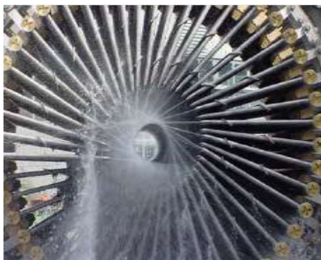
Figura 3.20 - Exemplo de um anel de têmpera por sprays de tubos.
