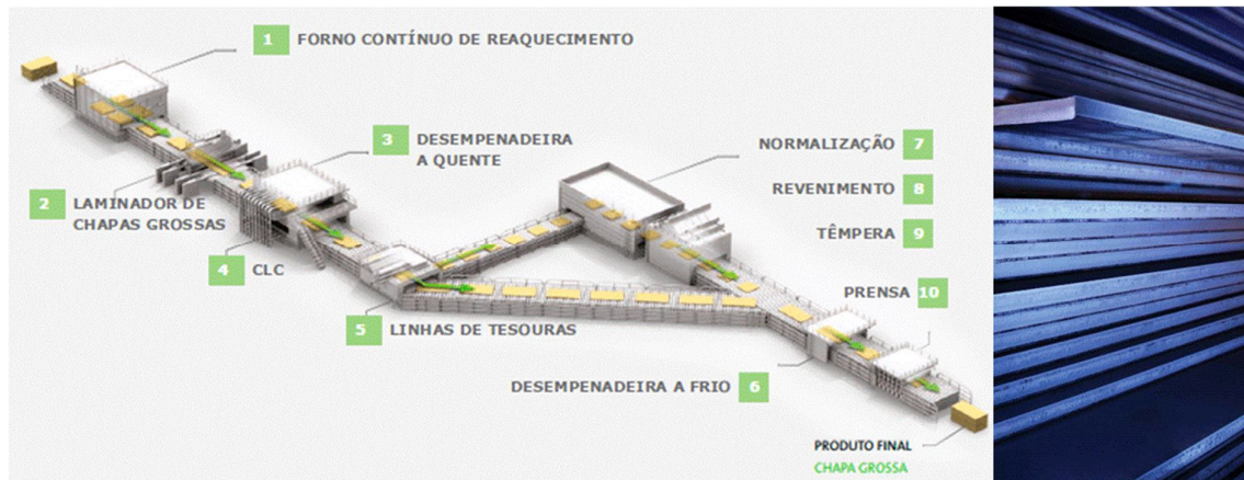
Figura 3.7 – Fluxo de Produção do Chapa Grossa (Fonte: www.usiminas.com ).
