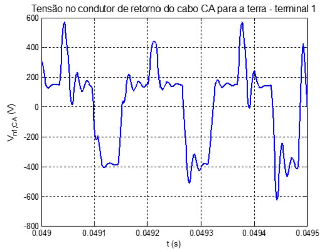
Figura 3.17: Tensão no condutor de retorno do cabo CA para a terra (caso II, terminal 1).
