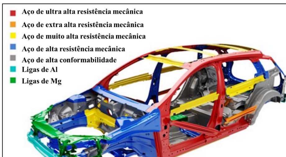
FIGURA 1.2 - BIW e seus principais componentes e materiais para um Volvo XC90 FONTE: Adaptado de LINDBERG, 2016.
