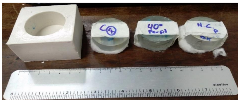
FIGURA 3.14 - Molde utilizado para embutimento a frio e exemplos de amostras metalográficas, já embutidas, identificadas FONTE: Autor, 2019
