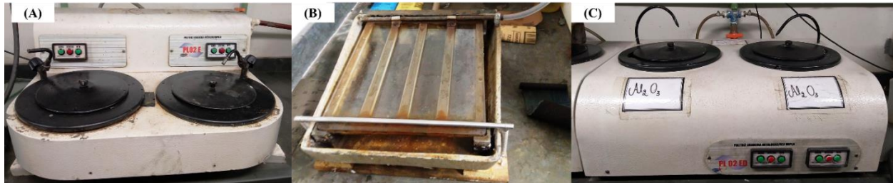
FIGURA 3.15 - Equipamentos utilizados para preparação metalográfica. (A) Lixadeira politriz automática (B) lixadeira de bancada manual e (C) politriz automática para uso de discos com alumina ( Al_2O_3 ) FONTE: Autor, 2019
