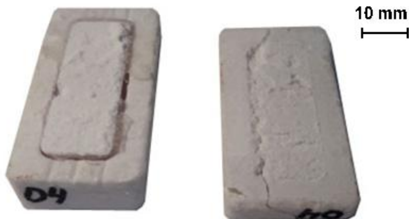
Figura 4.3: Condição dos moldes no processo de desmoldagem.
