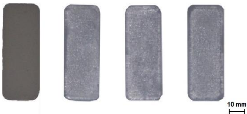
Figura 4.5: Resultado dos testes de termopolimerização, da esquerda para direita o primeiro é o grupo de controle obtido em molde tradicional e os demais obtidos em molde FR. O teste foi realizado em triplicata.
