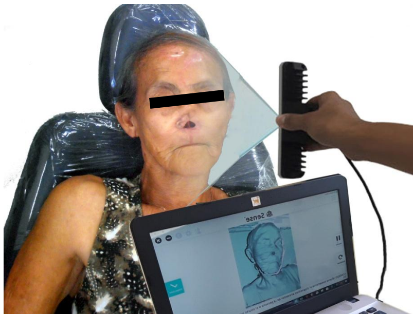
Figura 5.10 Processo de Digitalização 3D, paciente sendo digitalizada e imagem se formando software do equipamento.
