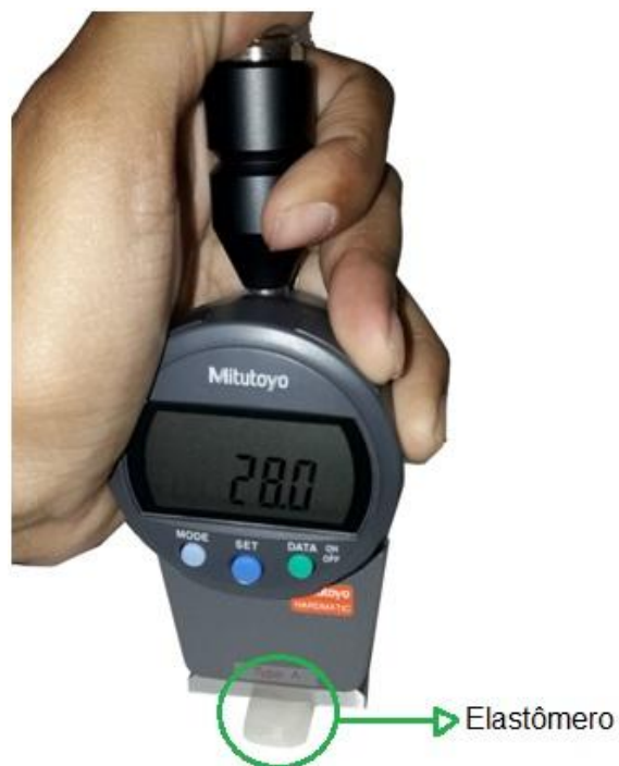
Figura 3.11: Testes com o durômetro para comparar a dureza do elastômero
