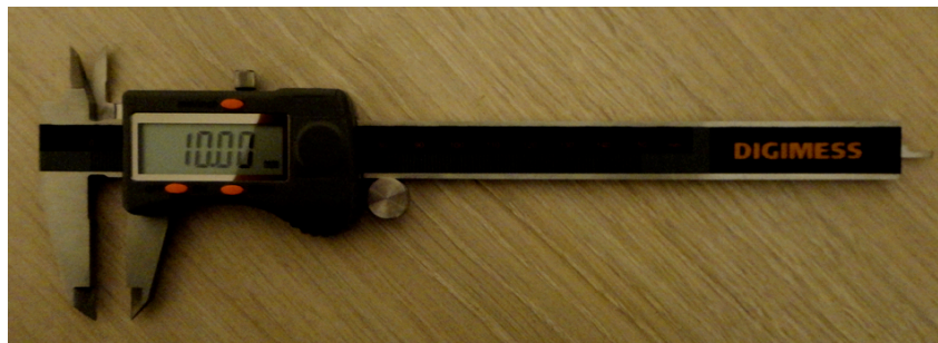
Figura 10 - Paquímetro de precisão profissional utilizado para aferir as medidas horizontais e verticais.
