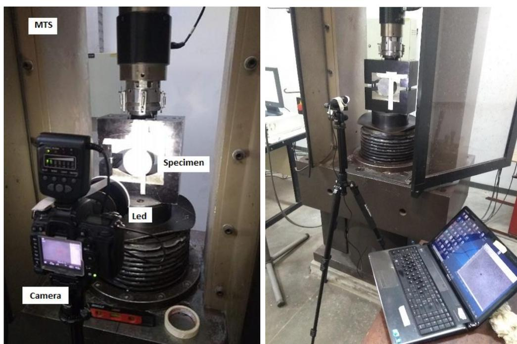
Figura 4.16: Montagem do teste utilizando câmera DSLR e microscópio USB
