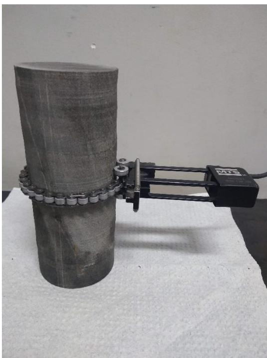
Figura 3.13: Extensômetro utilizado para medida de deformação radial
