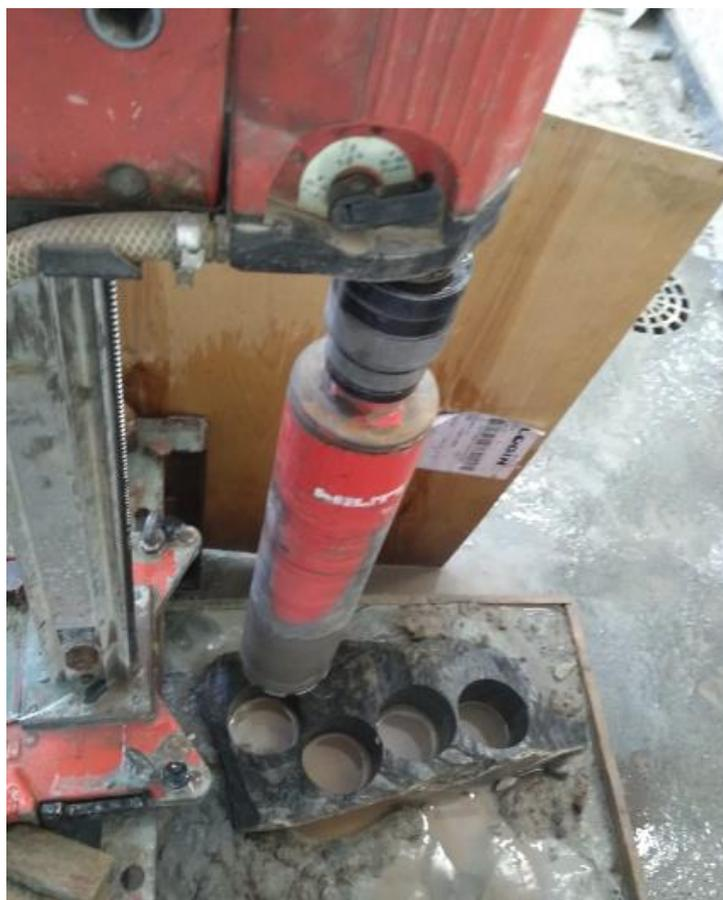
Figura 4.2: Processo de extração dos corpos de prova.
