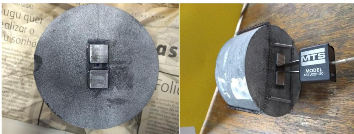
Figura 4.14: Montagem dos extensômetros modelo 632.02F-20 no corpo de prova
