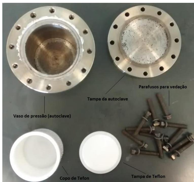
**Figura 3.7:** Vaso de pressão (autoclave) utilizado nesse estudo.
