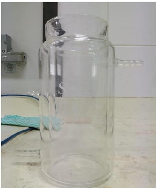
**Figura 4.5:** Fotoreator utilizado nos ensaios fotocatalíticos.
