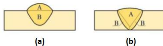
Figura 13. Parâmetros para medida da diluição na seção transversal de uma solda (a) sobre chapa, e (b) de topo. Fonte: MODENESI et al., 2012
