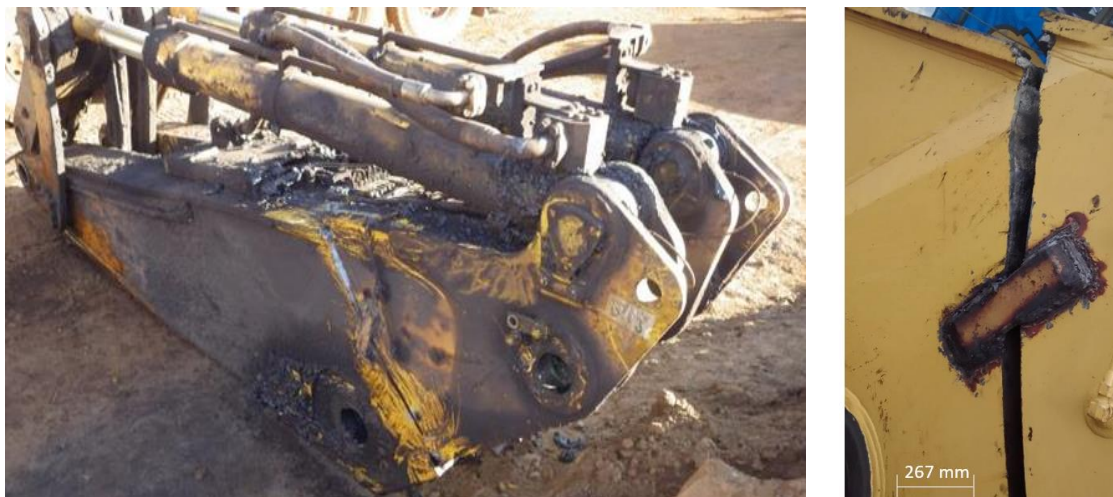
Figura 16. Trinca instável no semibraço da escavadeira hidráulica. Fonte: Autor
