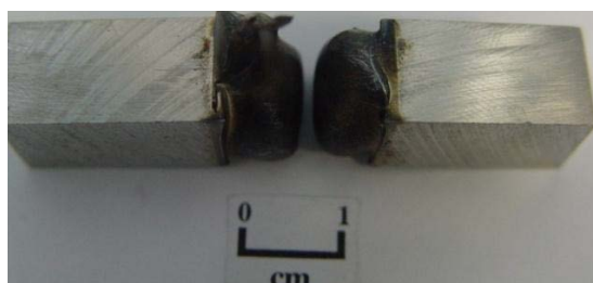
(a) Fusão na região de contato CP-Garra.
