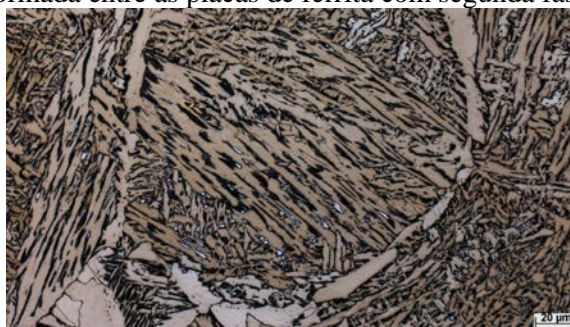
(d) Aspécto geral das diferentes formas do constituinte MA.
