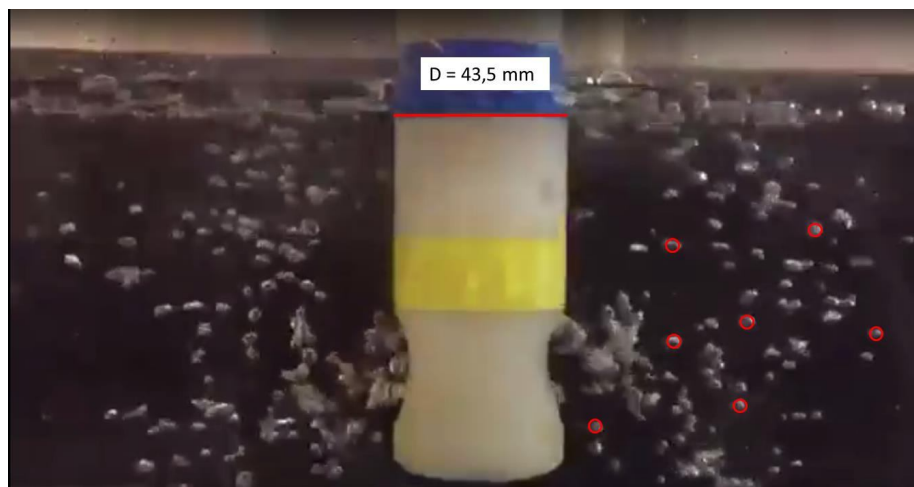
Figura 5.9 – Visualização do comportamento das bolhas próximo à saída da válvula submersa com injeção de gás de 2,5NL/min.
