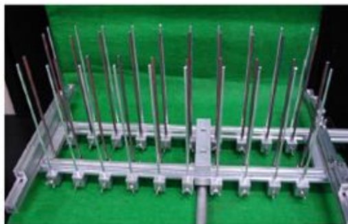
Figura 3.63 - Pregos fixados em um apoio de aço (DAUBY, 2012).
