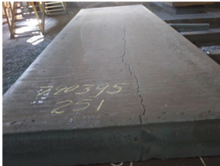
Figura 3.38 - Trinca Longitudinal em placa (OLIVEIRA, 2015).
