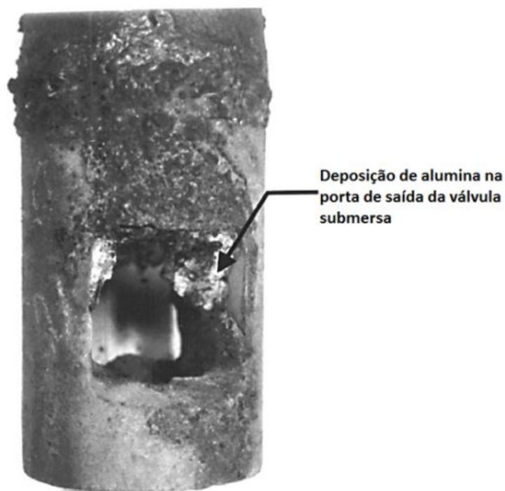
Figura 3.9 - Vista externa de uma válvula submersa com “clogging” (CRAMB, RASTOGGI e MADDALENA, 2003).
