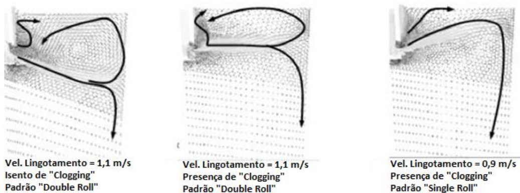
Figura 3.11 - Efeito da presença de “clogging” e velocidade de lingotamento no padrão de escoamento no molde (DOMGIN et al., 2005)
