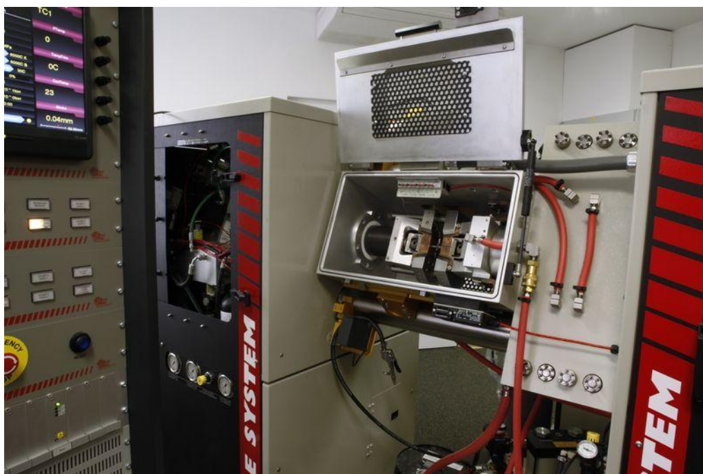
Figura 4.3–Equipamento de ensaios termomecânicos - Gleeble.
