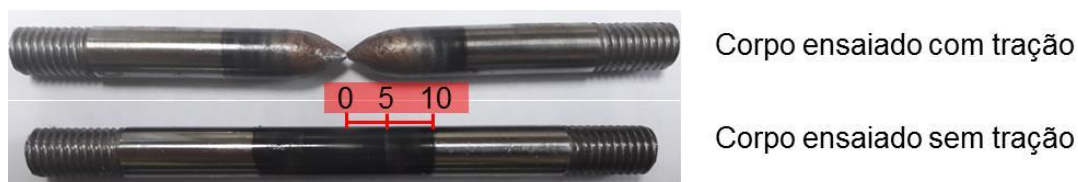
Figura 4.5 –Corpos de prova ensaiados na Gleeble com e sem tração.
