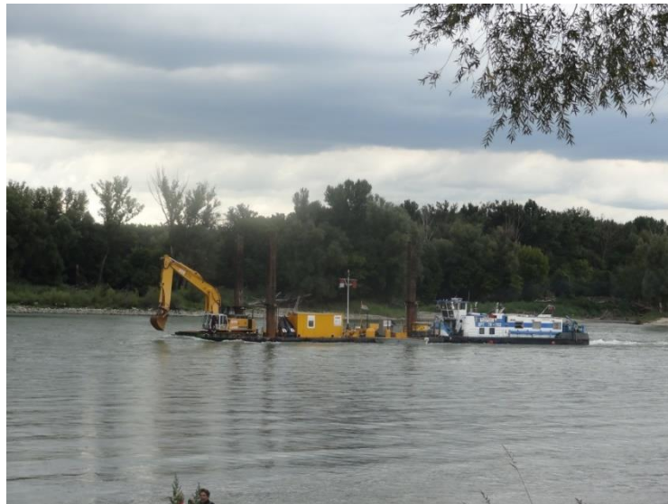
Figura 4-18: Rio Danúbio – Áustria – Draga que retira sedimentos a jusante e os transporta para montante
