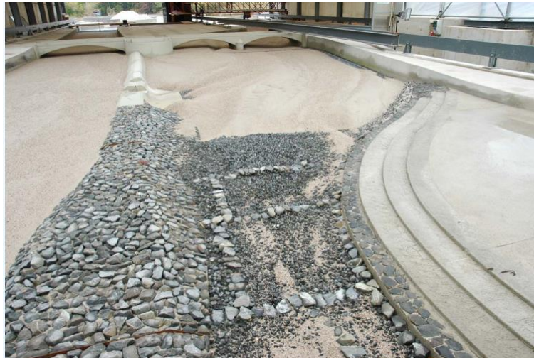
Figura 4-24: Modelo físico para simulação da dinâmica fluvial do Rio Isar Fonte: Mahida (2013)
