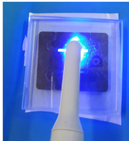
Figura 3 - Confeção dos corpos-de-prova para ensaio de resistência à flexão
