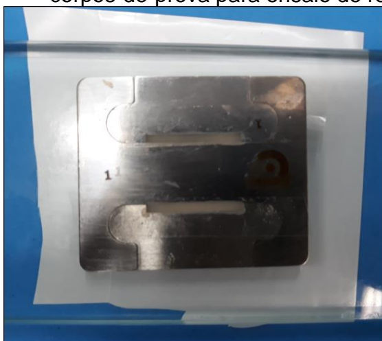
Figura 2 – Matriz metálica (25 x 2 x 2 mm) para confecção de corpos-de-prova para ensaio de resistência à flexão
