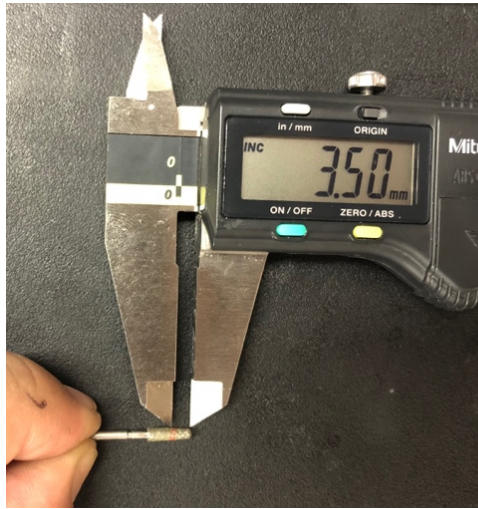
Figura 2 - Marcação padronizada da parte ativa da ponta adiamantada
