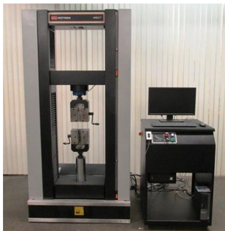
Figura E.3 Equipamento para ensaios mecânicos INSTRON 5582 com sistema de aquisição de dados Bluehill© Software
