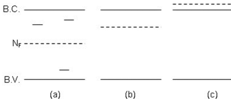
Figura B.1 Arranjo do nível de Fermi ( N_F ), em relação às bandas de valência (BV) e de condução (BC) em (a) isolantes, (b) semicondutores e (c) condutores.
