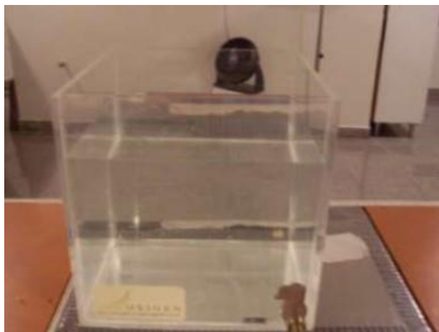
Figura 13 - Fantoma de água utilizado em calibrações nos aparelhos de radioterapia
