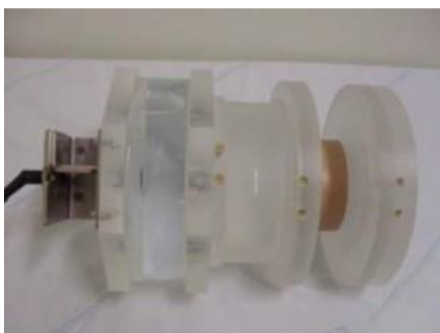
Figura 14 - Fantoma de acrílico utilizado em calibrações de tomógrafos
