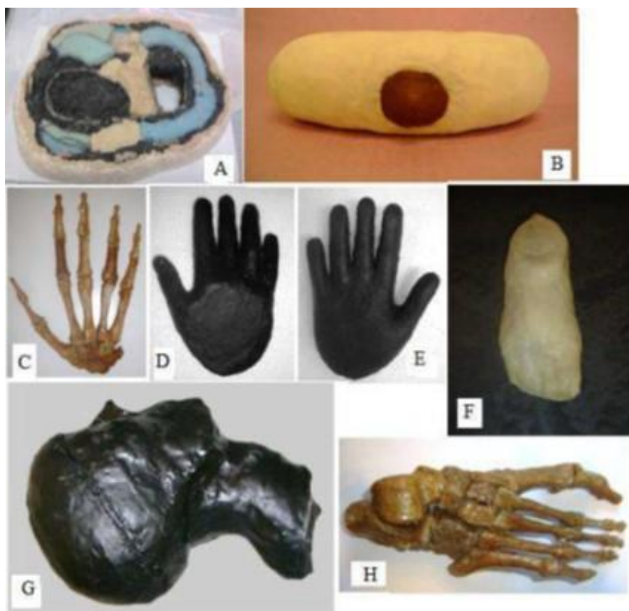
Figura 15 - Fantomas antropométricos e antropomórficos desenvolvidos pelo grupo NRI: (A) Simulador de seção abdominal, (B) mama comprimida, (C, D e E) fantoma de mão e (F) fantoma de pé, (G) fantoma de cabeça e pescoço.
