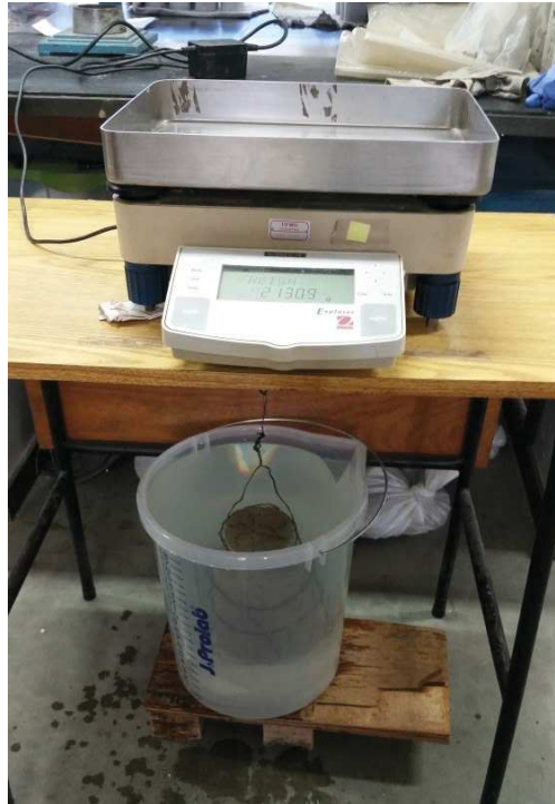
Figura 28 – Balança hidrostática para determinação da massa submersa em água
