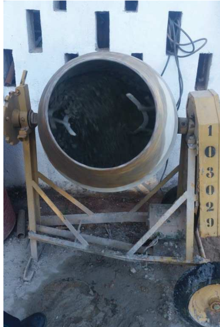
Figura 17 – Detalhe da betoneira elétrica utilizada durante a produção do concreto
