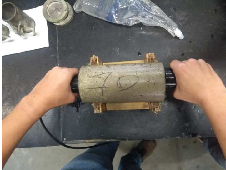
Figura 25 – Representação do posicionamento dos transdutores
