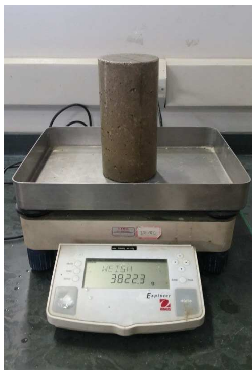
Figura 29 – Determinação da massa saturada dos corpos de prova
