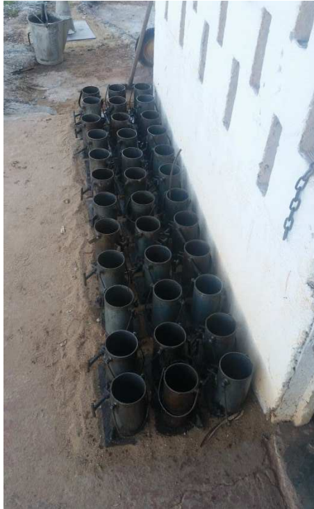
Figura 16 – Formas já preparadas para produção dos corpos de prova.
