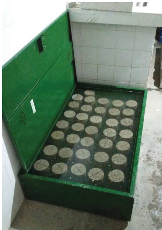
Figura 18 – Detalhe da cura submersa dos corpos de prova
