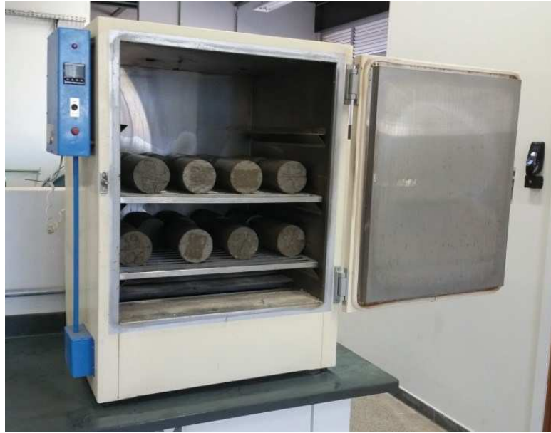
Figura 27 – Secagem dos corpos de prova em estufa
