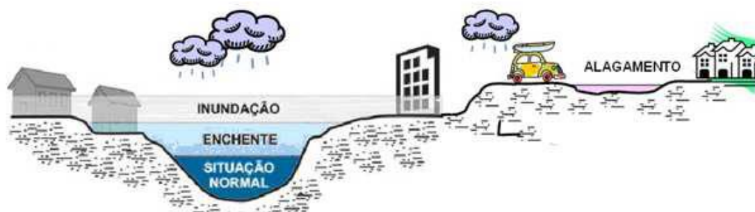
Figura 30 - A inundação, a enchente e o alagamento.
