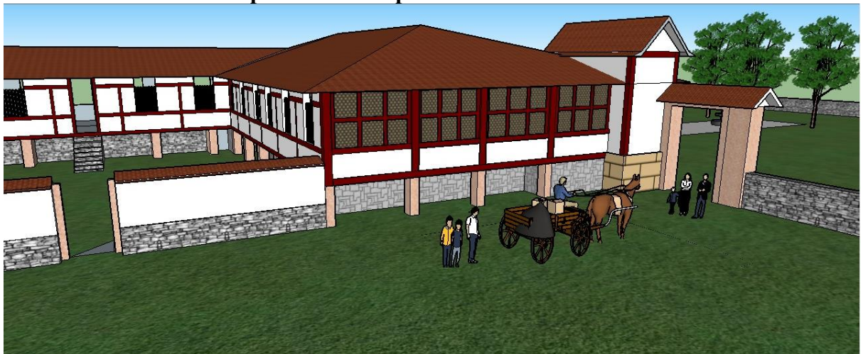
Figura 106: Reconstituição de vizinhos chegando para um ofício na ermida da Fazenda Boa Esperança - a treliça da varanda lateral funcionaria como barreira visual promovendo a privacidade da família
