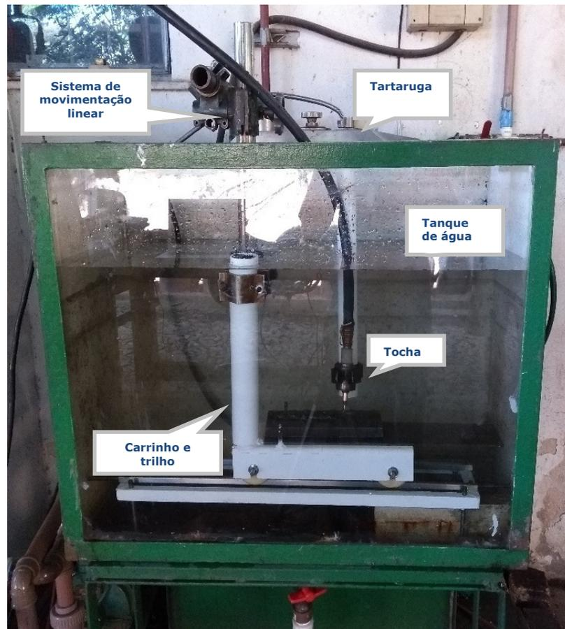
Figura 4.1: Aquário e sistema de deslocamento linear
