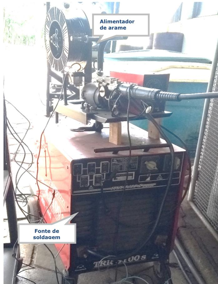
FIGURA 4.3: Fonte de soldagem e cabeçote de solda.
