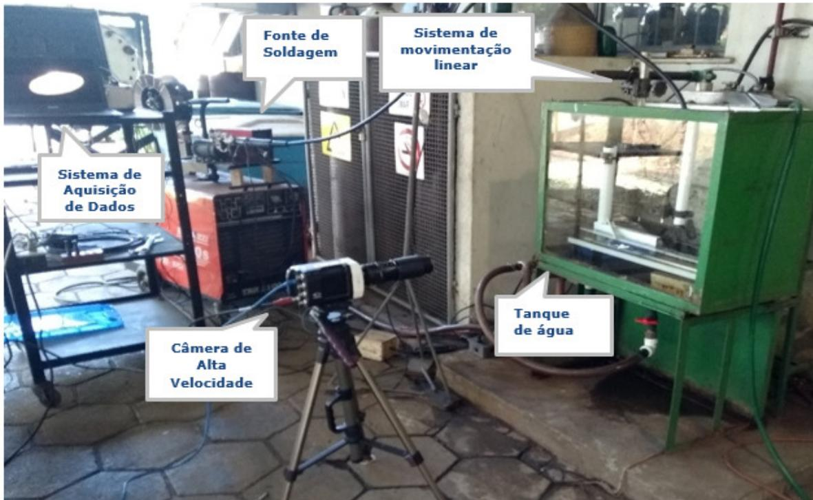
FIGURA 4.4: Configuração Experimental
