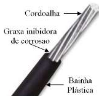
Figura 13 – Detalhe de uma cordoalha de 7 fios
