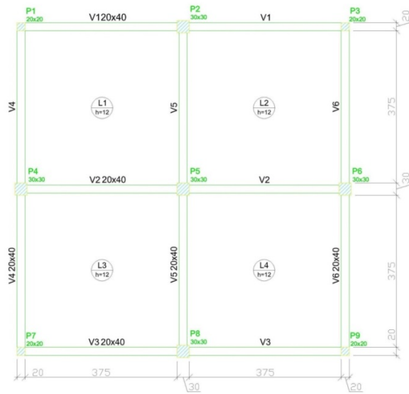
Figura 17 – Planta de forma do pavimento tipo (dimensões em cm).
