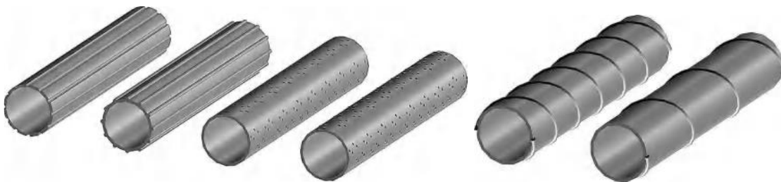
Figura 3-20 Modificação na seção transversal do cabo para evitar vibrações induzidas por chuva e vento (GIMSING; GEORGAKIS, 2012).
