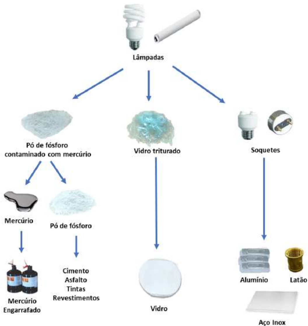
Figura 3.1. Fluxograma para reciclagem de lâmpadas fluorescentes (Apliquim Brasil, 2019)
