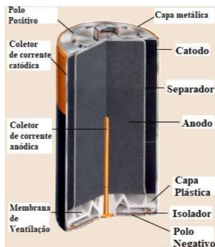
Figura 2.1. Esquema de uma bateria alcalina comum (Duracell, 2012).
