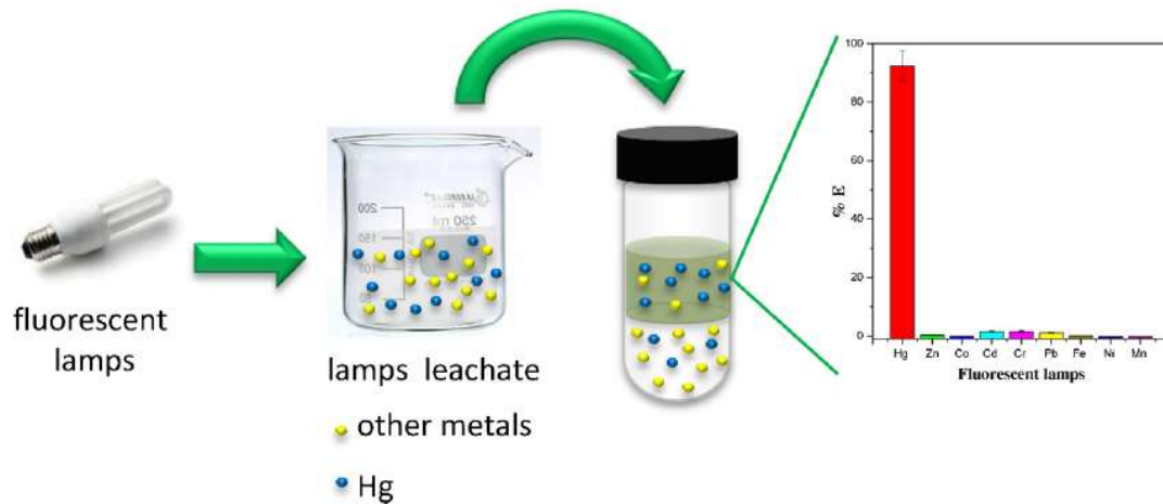
Figura 1.10. Esquema para recuperação de Hg provenientes de lâmpadas fluorescentes empregando sistemas aquosos bifásicos (da Cunha et al. , 2016).
