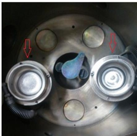
**Figura 10** - Cadinho onde estão dispostos os alvos zircônio e silício dentro da câmara de sputtering do equipamento Orion 5-HV Sputtering Systems.
