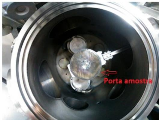
**Figura 9** - Câmara de sputtering do equipamento Orion 5-HV Sputtering Systems vista por dentro.
