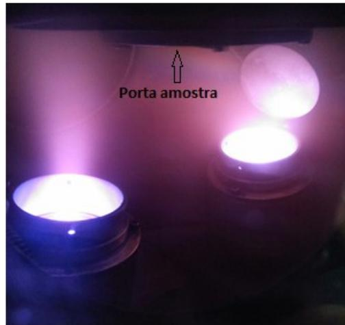
**Figura 11** - Plasma formado no interior da câmara de *sputtering* do equipamento Orion 5-HV Sputtering Systems.
