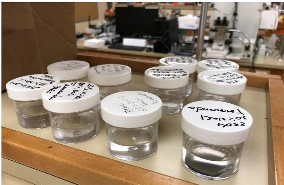
**Figura 14** - Reservatórios utilizados para imersão das amostras durante o teste espectroscopia de impedância eletroquímica de longa duração.
