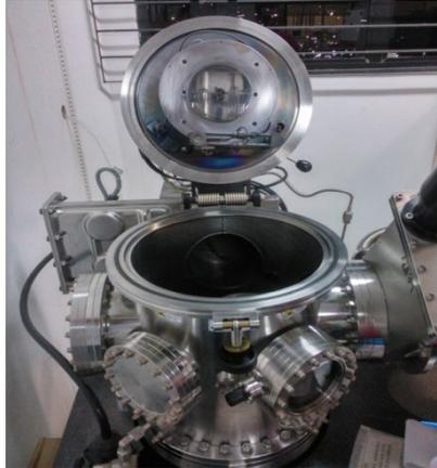
**Figura 8** - Câmara de sputtering do equipamento Orion 5-HV Sputtering Systems vista por fora.
