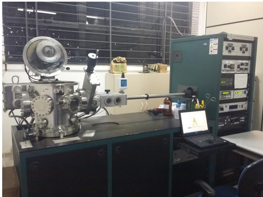
**Figura 7** - Equipamento de deposição de filmes finos pela técnica de *magnetron sputtering*, Orion 5-HV Sputtering Systems.
