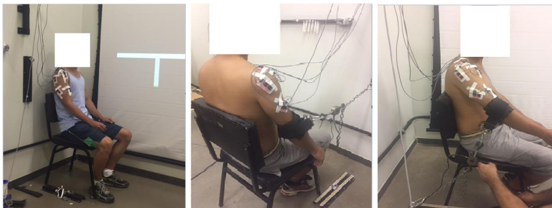
Figura 7 - Barras rígidas, correntes, abraçadores e cadeira utilizados para realização do teste de CVIM.
