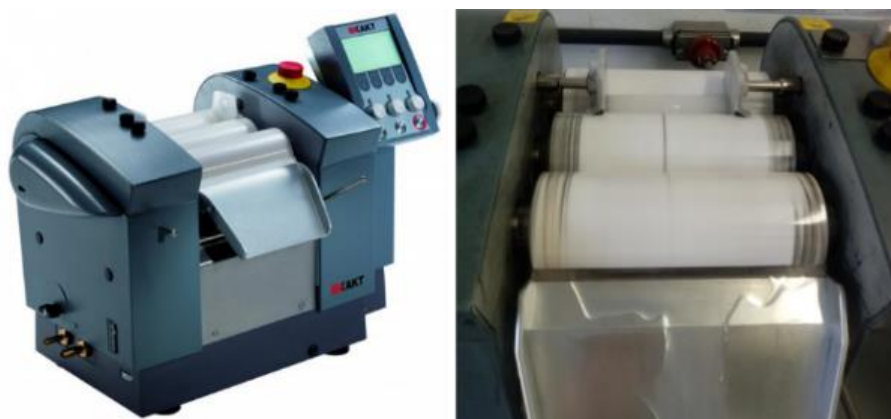
Figura 19 - Processamento da resina epóxi e das nanopartículas de \text{CaCO}_3 no moinho de três rolos Exakt 80E.
