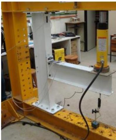
FIGURA 3.6 – Ensaio experimental de ligação parafusada CHAMBERLAIN *et al.* (2013)
