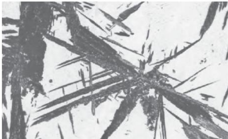
Figura 3.10 - Bainita inferior no aço 4360 transformado em 300°C, resolução de 750x, (HEHEMANN, 1973).
