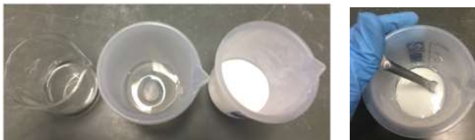
Figura 4.24 - Moldagem do geopolímero com aluminossilicato (ANN)
