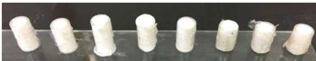
Figura 4.29 - Moldagem dos geopolímeros com aluminossilicato (IPA)
