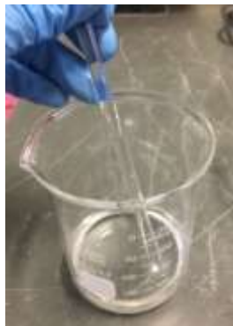
Figura 4.22 - Mistura dos ativadores alcalinos (silicato de sódio e hidróxido de sódio)
