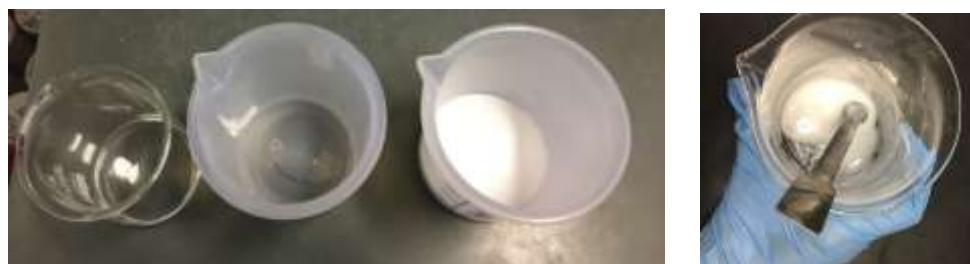
Figura 4.25 - Moldagem do geopolímero com aluminossilicato (IPA)
