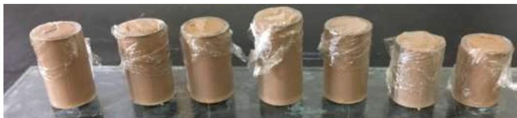
Figura 4.27 - Moldagem dos geopolímeros com metacaulim
