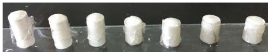
Figura 4.29 - Moldagem dos geopolímeros com aluminossilicato (IPA)
