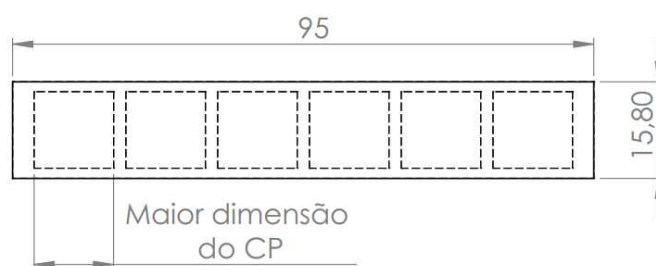
Figura 4.2: Desenho esquemático para usinagem dos corpos de prova a partir de tarugos recozidos. Dimensões em mm.
