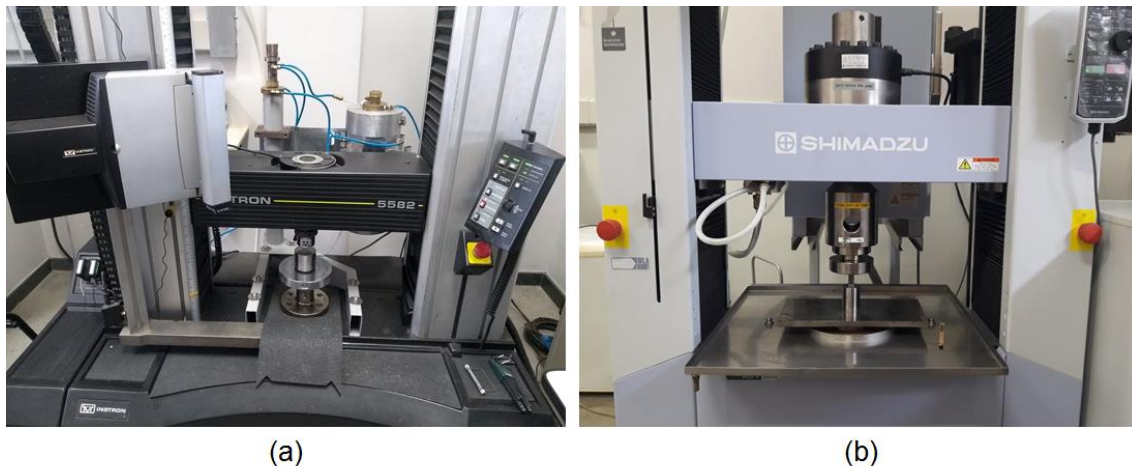
Figura 4.6: Máquina de ensaios INSTRON com matriz posicionada para realização de forjamento multidirecional em canais confinados (MDF confinado) com amplitude de 0,075 (a); Máquina de ensaios SHIMADZU com matriz posicionada para realização de MDF confinado com amplitude de 0,5 (b).
